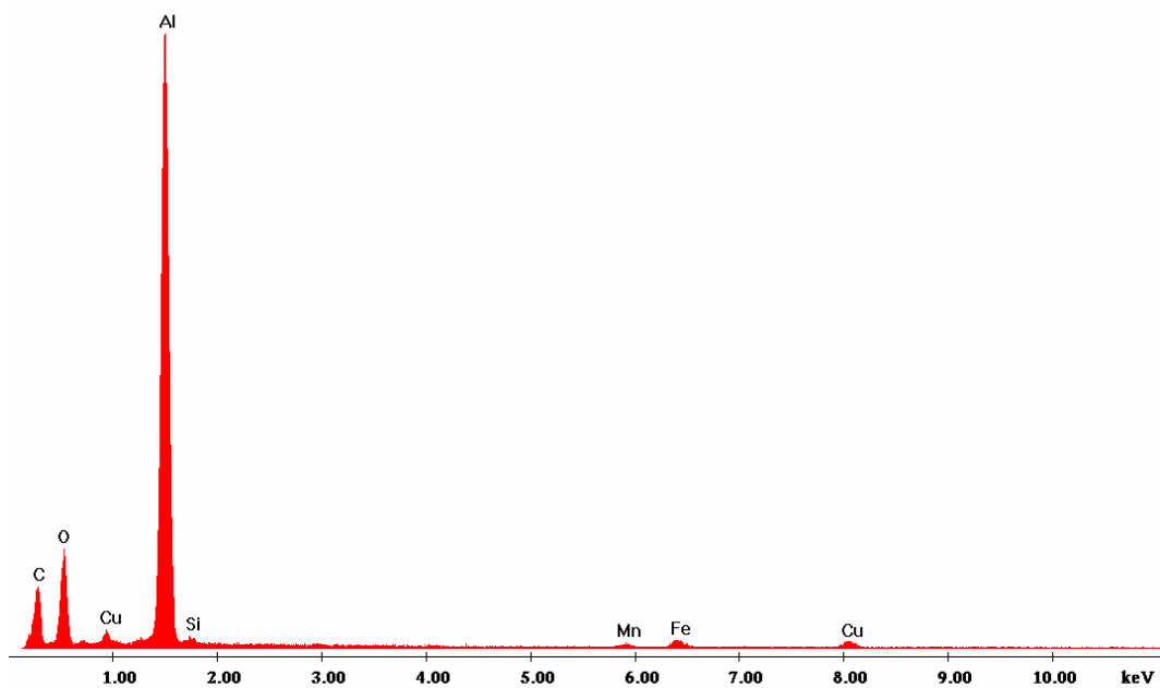
Fig. 27, Analisi 7 della tabella II. La figura mostra un'immagine morfologica ad alto ingrandimento di un aggregato di particelle. L'analisi chimica EDS mostra che tali particelle sono composte da Alluminio, Ossigeno, Carbonio, Rame, Ferro, Manganese e Silicio.
