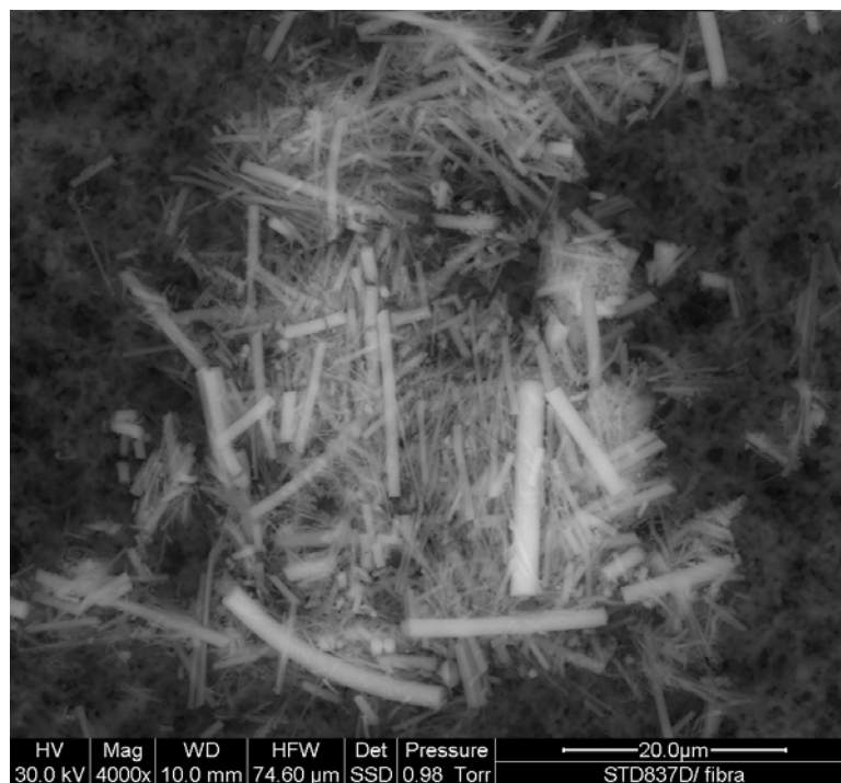
Figg. 78 e 79, Analisi 17 e 18 della tabella IV. Le figure mostrano immagini morfologiche ad alto ingrandimento di aree del campione analizzato ove sono visibili numerose fibre sia di tipo A sia di tipo B.
